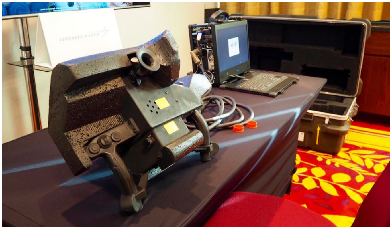
Zestaw do szkolenia strzelców systemu ppk Javelin. Po lewej moduł celowniczy wyrzutni (CLU), po prawej symulator - fot. J.Sabak
