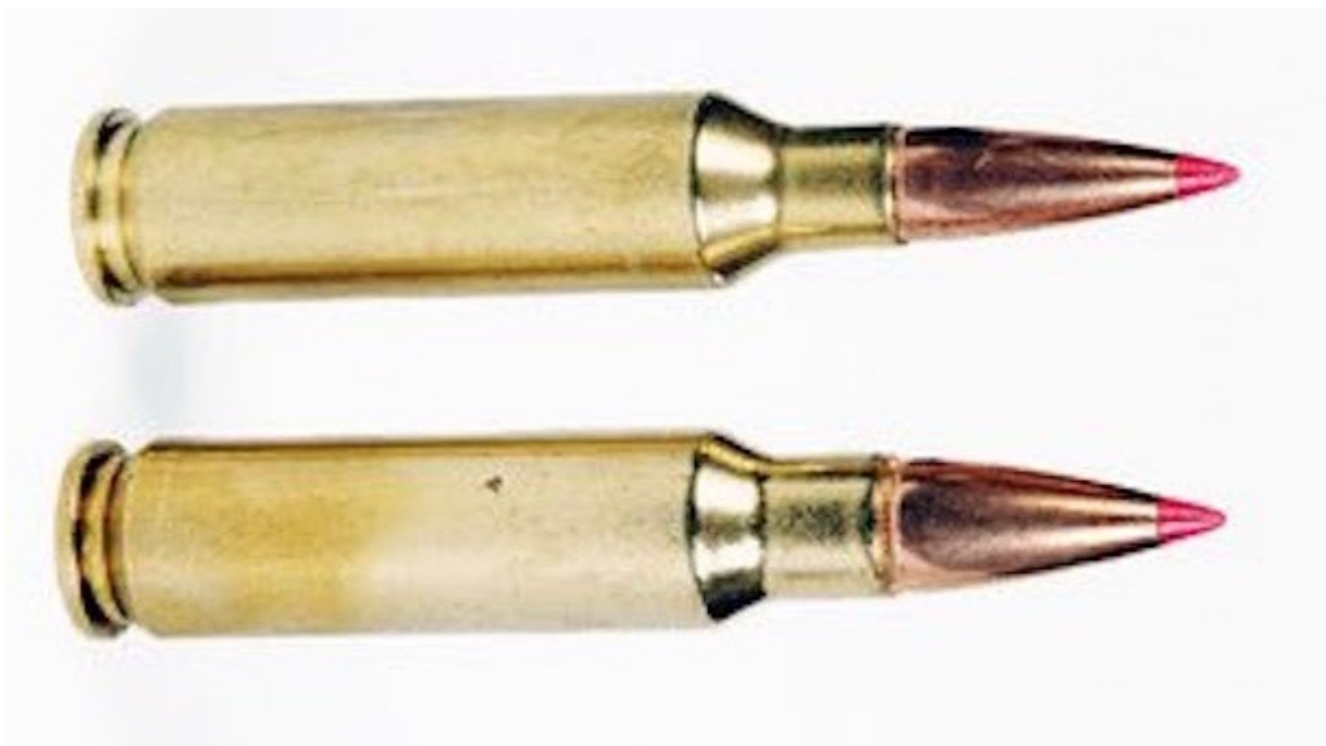
Porównanie naboju 6,5 mm Creedmoore (na górze) i 7,62 mm NATO (na dole) pokazuje jak zbliżone są ich wymiary, co ułatwia konwersję broni. Fot. US Army
