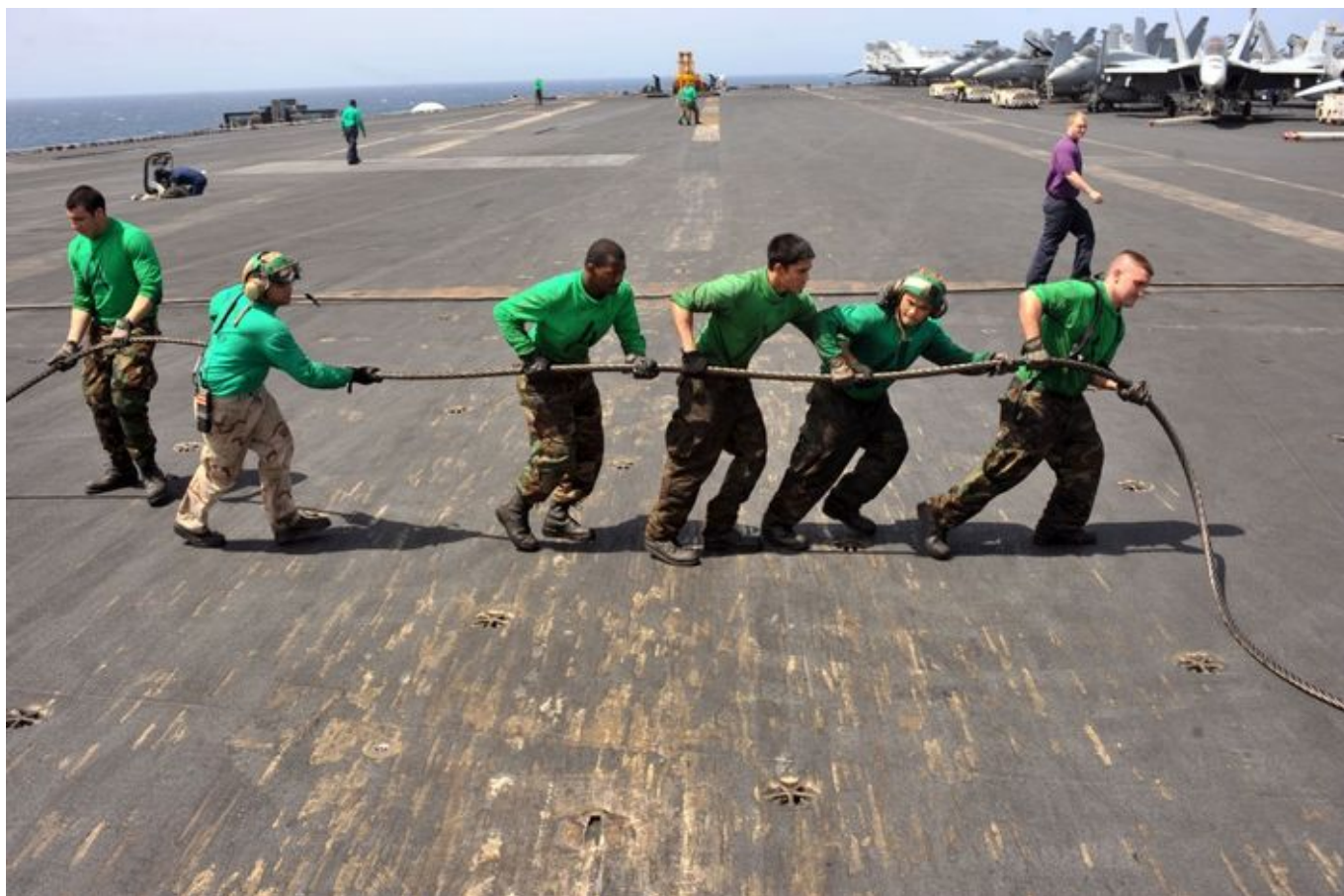
Wymiana „przewodów aresztujących” odbywa się zawsze, profilaktycznie po dwutysięcznym lądowaniu. Na zdjęciu operacja wymiany liny kadmującej na lotniskowcu USS „Enterprise” (CVN 65). Fot. J.M. King /US Navy
