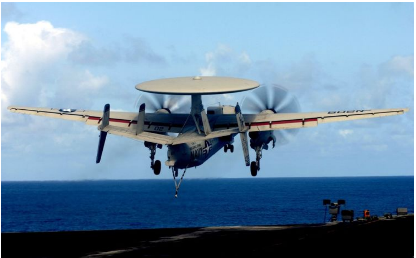
Jeżeli samolot nie trafi w linę hamującą, musi się wznieść, wykonać dodatkowy krąg i ponownie podejść do lądowania. Na zdjęciu awaryjny start samolotu E-2C Hawkeye na lotniskowcu USS „John C. Stennis” (CVN 74) w czerwcu 2007 r. Fot. J.Hyde/US Navy
