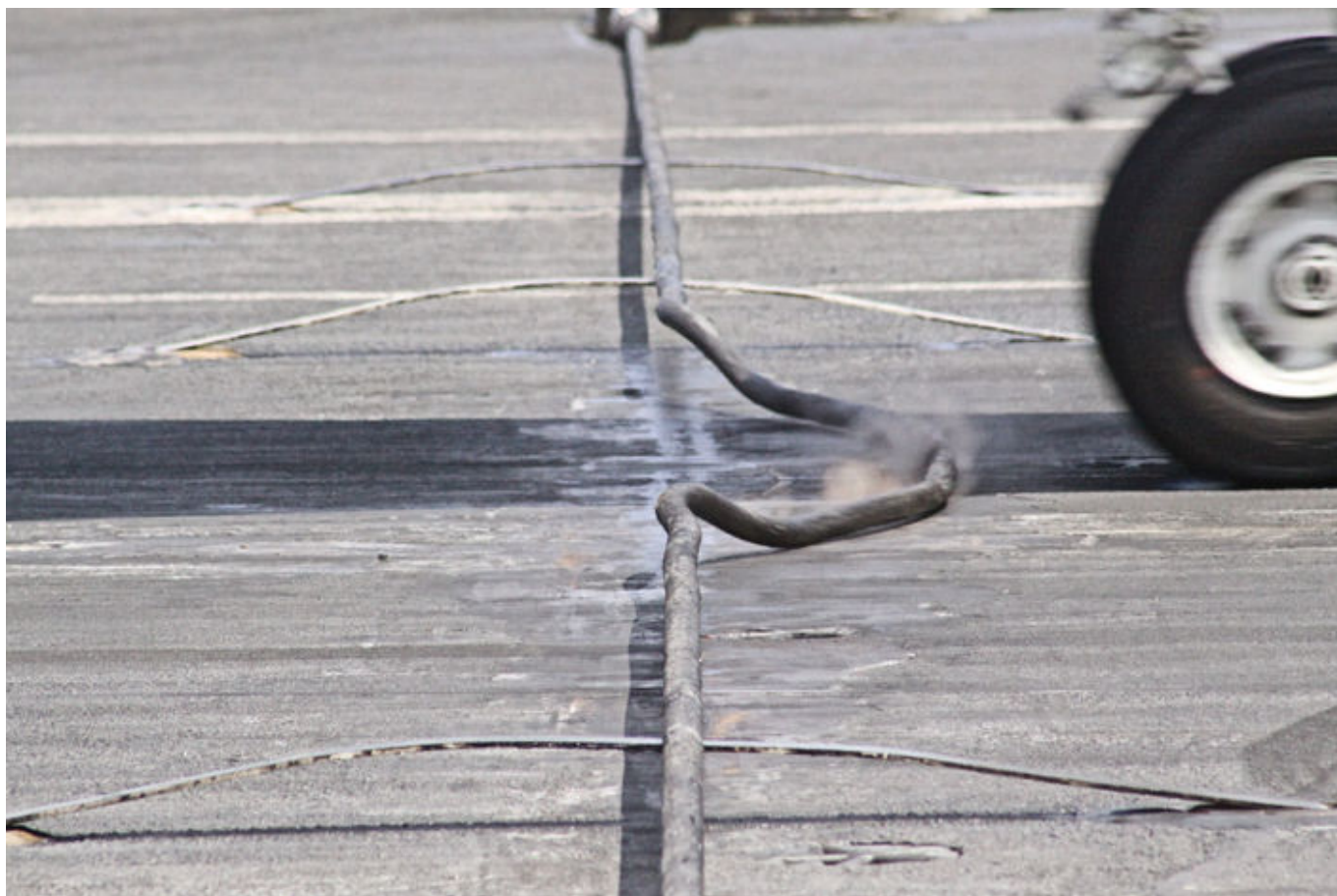
Liny hamujące zużywają się nie tylko po zaczepieniu haka, ale również gdy koła samolotu przejadą po nich na pokładzie. Fot. US Navy/Wikipedia
