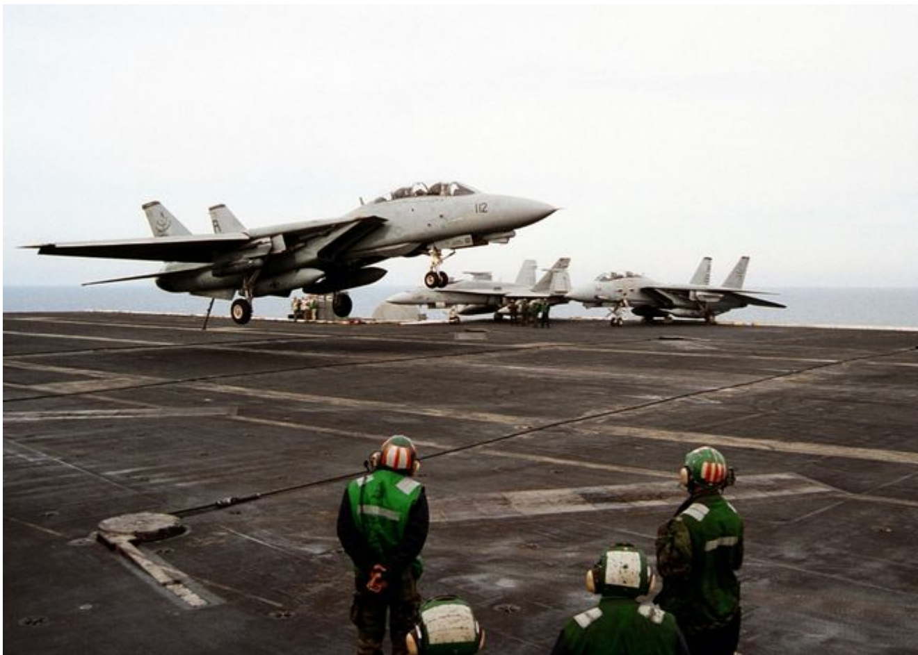
Lądowanie samolotu F-14 Tomcat na lotniskowcu USS „Theodore Roosevelt” w marcu 2002 r. Widoczne trzy liny hamujące. Fot. S.A. Day/US Navy
