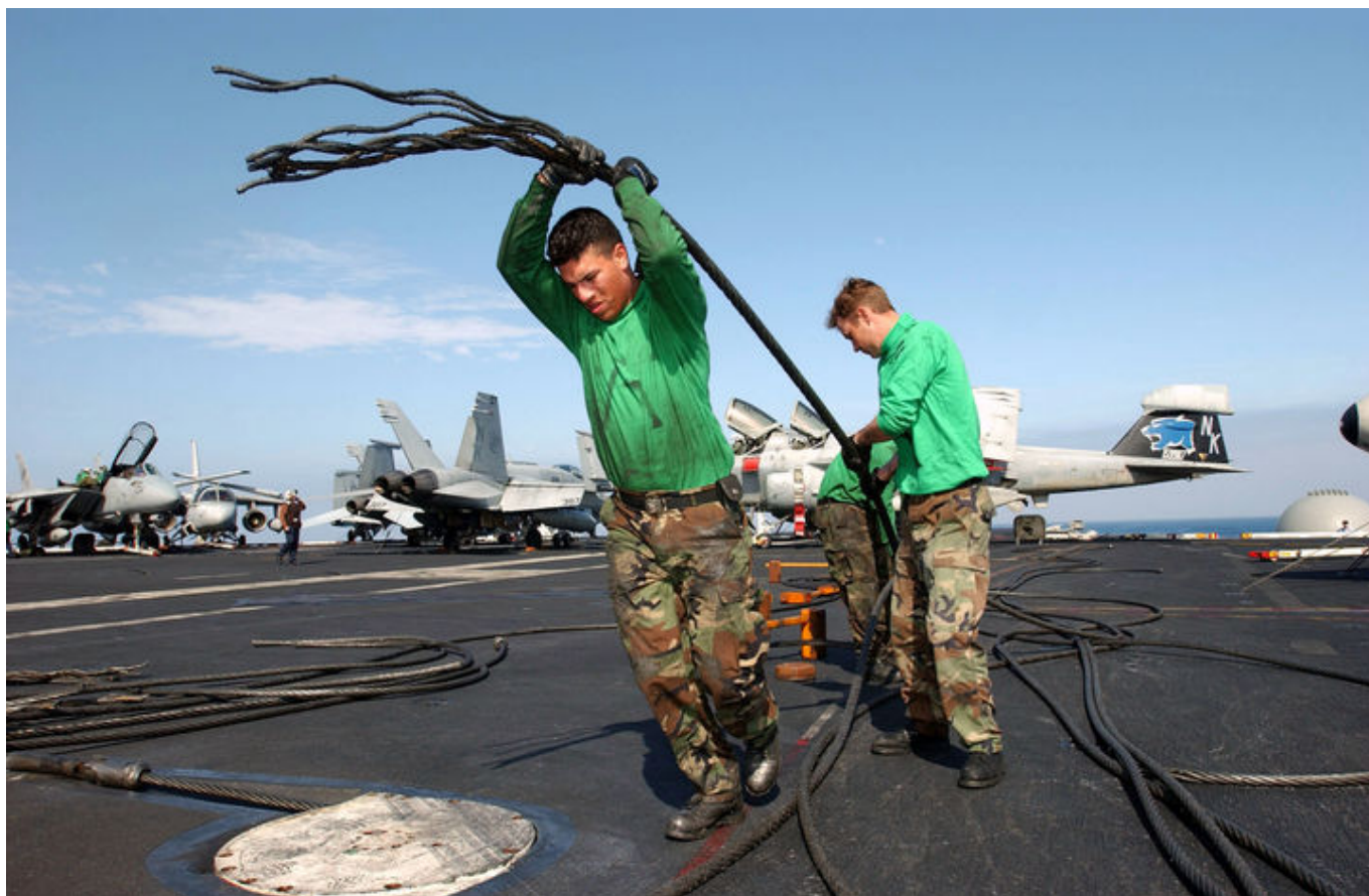
„Przewody aresztujące” są wykonane z ciasno tkanego drutu stalowego o wysokiej wytrzymałości na rozciąganie, ale mogą ulec uszkodzeniu. Są wtedy jednak bardzo szybko wymieniane. Fot. US Navy
