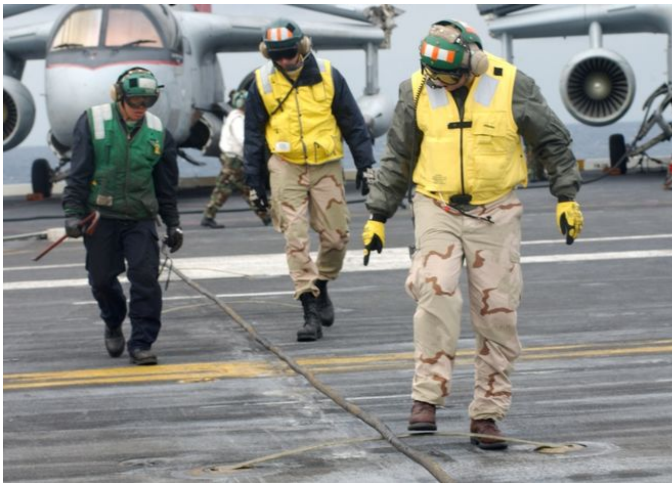
Przegląd lin hamujących jest jedną z najważniejszych czynności personelu pokładowego przed rozpoczęciem operacji lotniczych. Na zdjęciu sprawdzenie realizowane na lotniskowcu USS „Theodore Roosevelt” w grudniu 2002 r. Fot. S. A. Day/US Navy
