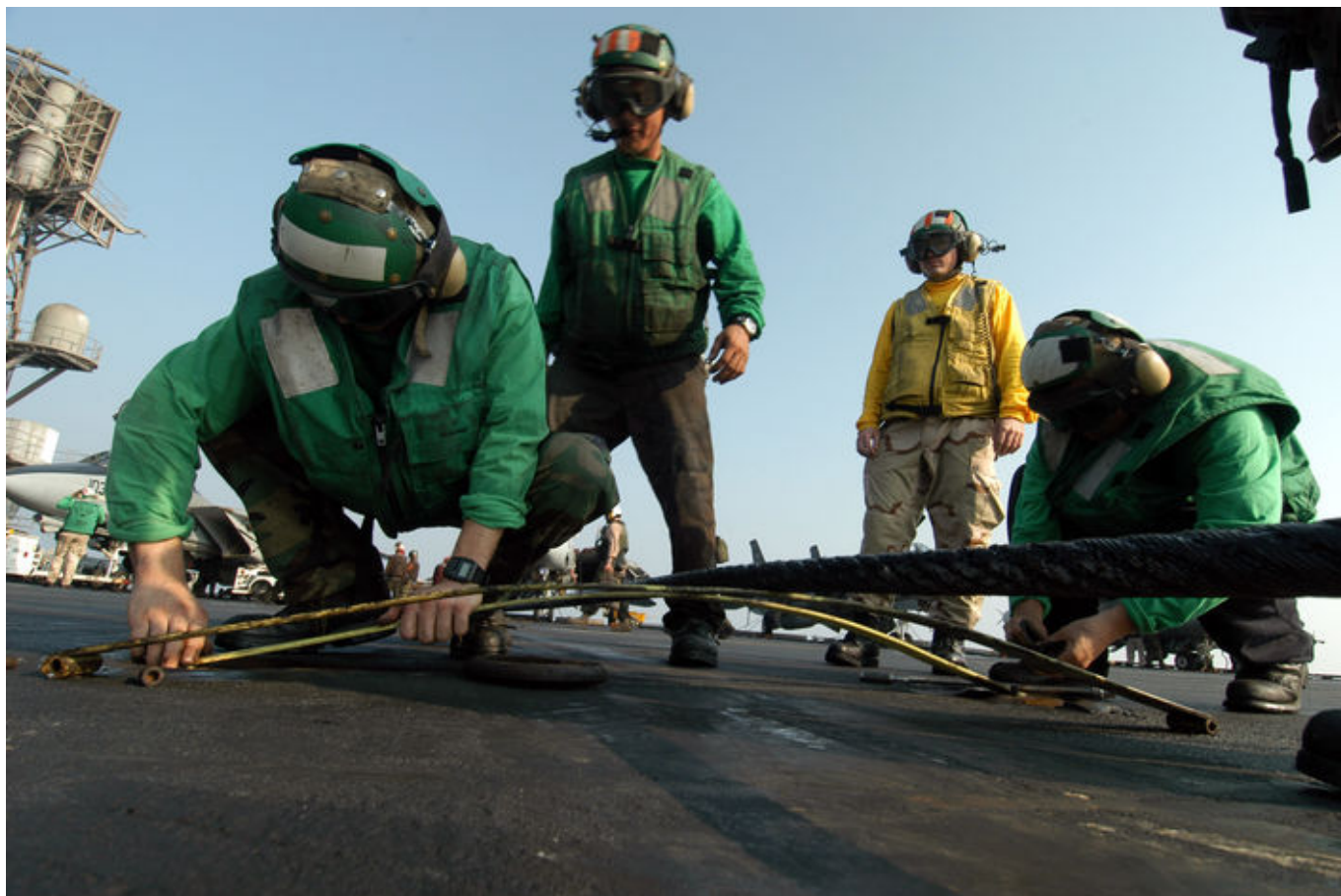
Liny hamujące są utrzymywane na pewnej wysokości nad pokładem dzięki specjalnym łukowym podporom. Fot. J.Karsten/US Navy
