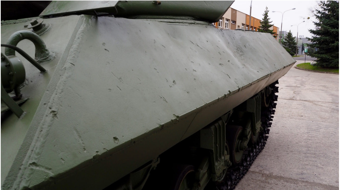
Ślady poligonowej przeszłości Achillesa - liczne rysy i potężne wgniecenie bocznego pancerza po trafieniu pociskiem artyleryjskim. Fot. J.Sabak
