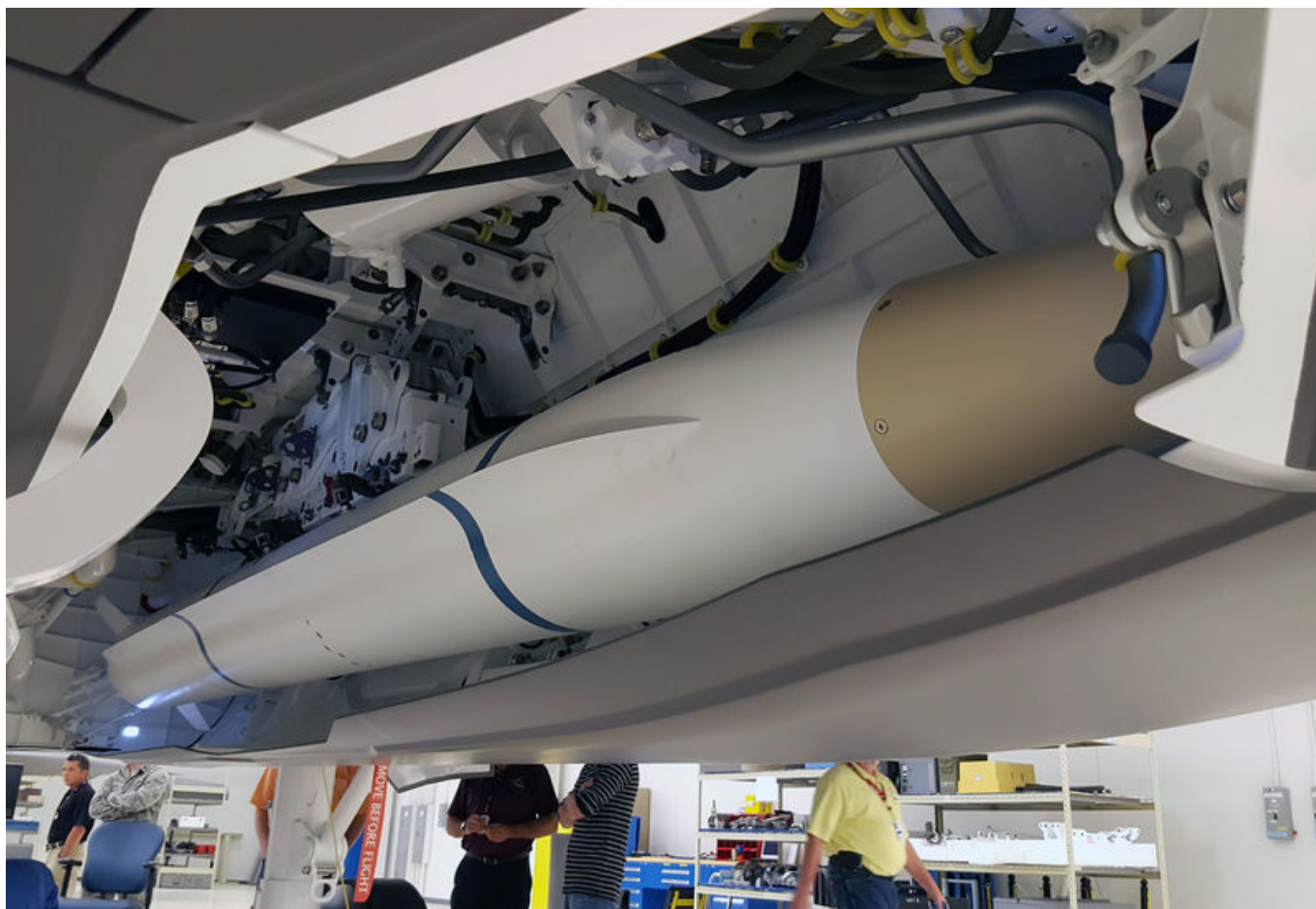
Demonstrator koncepcji AARGM ER w komorze F-35. Fot. Northrop Grumman.
