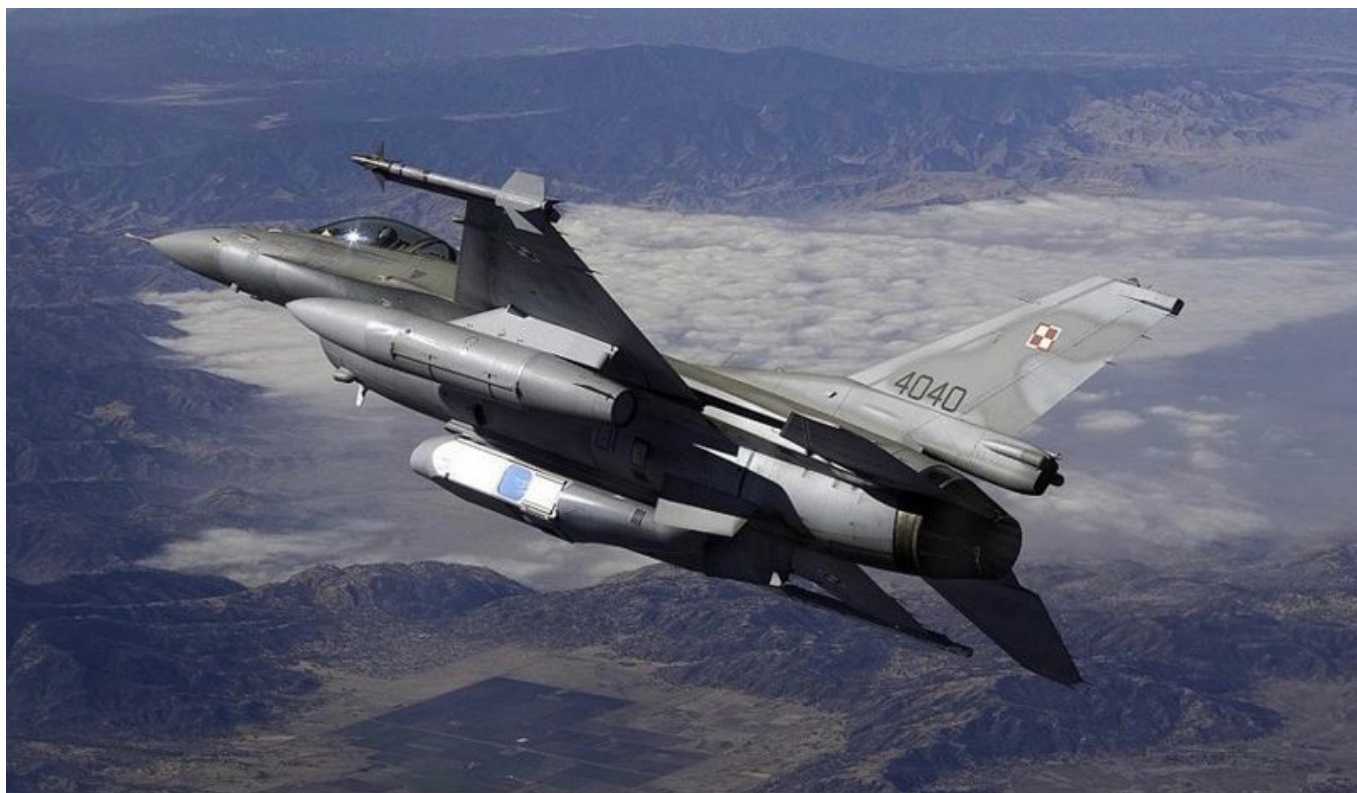
Polski F-16C z zasobnikiem DB-110 - fot. Lockheed Martin Tactical Aircraft Systems
